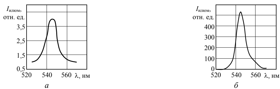
Рис. 1. Относительная интенсивность люминесценции иона Tb(III) с ТОФО в отсутствие (а) и в присутствии (б) Тритона X-100 ( C_{Tb} = 1 \cdot 10^{-4} моль/л, C_{ТОФО} = 3 \cdot 10^{-4} моль/л)
